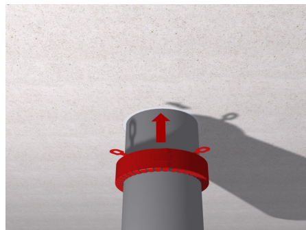
5. Die Brandschutzmanschette mit den mitgelieferten Schrauben direkt an die Unterseite der Decke montieren.
