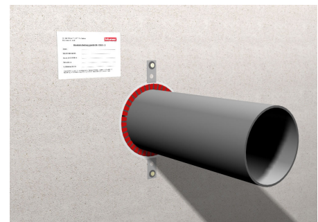
7. Die Metallstreifen um 90° biegen und mit Trockenbauschrauben befestigen. Am Ende die Abschottung gut sichtbar beschriften.
