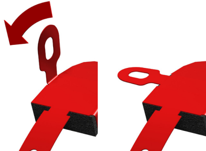
2. Die Laschen der Brandschutzmanschette um 90° nach hinten biegen.
