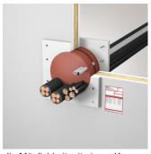
Bei zu geringer Einbaustärke gibt es die Möglichkeit mit einem Kragen aus Brandschutzplatten RF1 aufzudoppeln (siehe Bild rechts).
