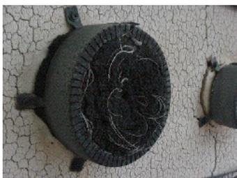
Intumex® RS 10 bewirkt im Brandfall einen raschen und sicheren Rohrverschluss, gemäss Testbilder innert 3 Minuten. Der Verschluss hält im Feuer während mindestens 90 Minuten dicht. In diesem Fall sind beide Rohrenden offen, dh. das Innere des Brandofens ist sichtbar, was der Konfiguration U/U entspricht.
