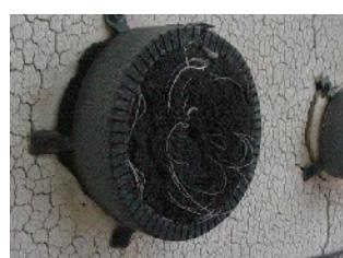
En cas d'incendie, les manchettes coupe-feu Intumex® RS10 ferment le tuyau de façon rapide et sûre en 3 minutes. Sous l'effet du feu, la fermeture se maintient étanche au moins 90 minutes. Les deux bouts du tuyau sont ouverts, c'est-à-dire, l'intérieur de la chambre de chauffage est visible au début de l'essai, ce qui correspond à la configuration U/U.
