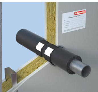
Tube métallique avec isolation combustible dans une obturation souple Intumex CSP 1 x 50 mm ou dans un carottage, posé dans une paroi légère
