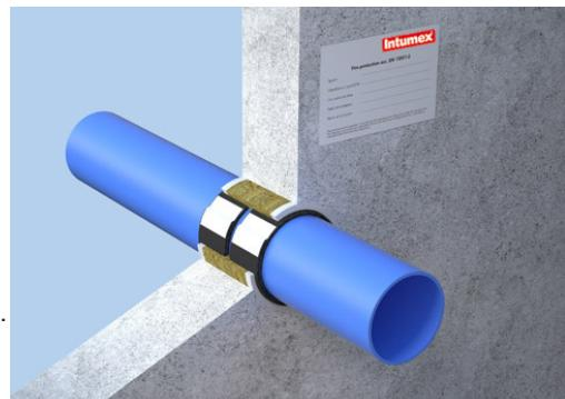
Montage de tuyaux en plastique: mur des deux côtés, plafond en dessous.
