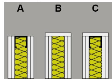
\* Dans les essais avec application unilatérale, Intumex® AN n'a été appliquée que du côté non-exposé au feu respectivement que du côté exposé au feu
