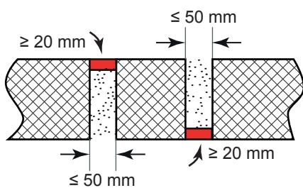
D'un côté EI90: mur - mur
