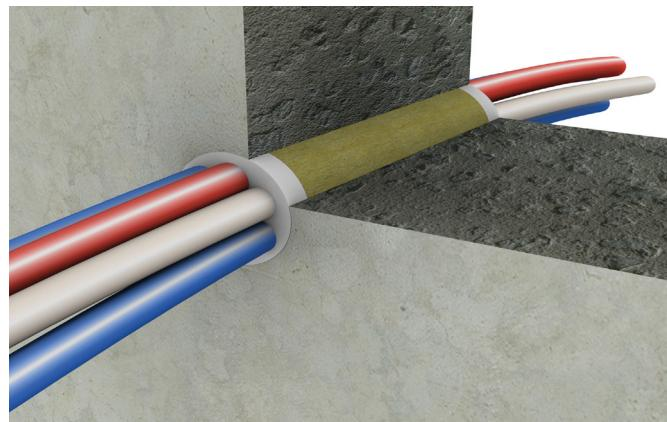
Vue tridimensionnelle d'une obturation coupe-feu EI90 d'un faisceau de câbles des deux côtés d'un mur massif avec Intumex® AN (largeur 20 mm, profondeur 15 mm). Remplir d'abord avec de la laine de roche non inflammable.
