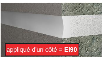
Murs ( $\geq 100$  mm) et plafonds massifs ( $\geq 150$  mm) avec fond de joint RF1,  $T \geq 1000$  °C  $\geq 40$  kg/m<sup>3</sup>, p.ex. laine minérale (No. AEA1 33329)
