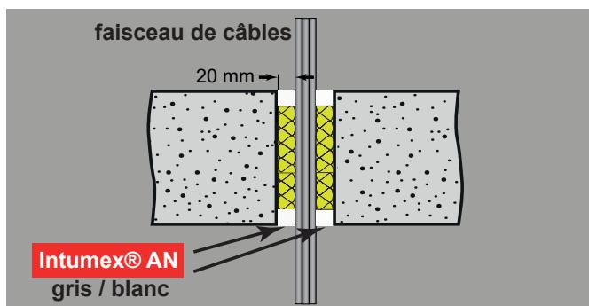
Obturation coupe-feu EI90 d'un faisceau de câbles avec le mastic acrylique Intumex® AN (largeur 20 mm, profondeur 15 mm) à travers un plafond massif. Remplissage de l'ouverture d'abord avec de la laine de roche (A1 → RF1).
