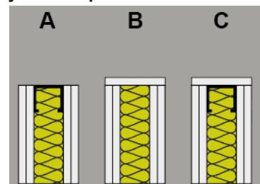
Parois légères ( $\geq 100$  mm) avec fond de joints RF1,  $T \geq 1000$  °C  $\geq 40$  kg/m<sup>3</sup>,
