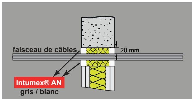
Obturation coupe-feu EI90 d'un faisceau de câbles avec le mastic acrylique Intumex® AN (largeur 20 mm, profondeur 15 mm) à travers une paroi de construction légère ou un mur massif. Remplissage de l'ouverture d'abord avec de la laine de roche (A1 → RF1).
