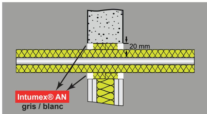
Obturation de l'espace annulaire autour d'un tuyau en acier isolé avec de la laine de roche de façon continue ( $> 1000$  °C, mind. A2-s1,d0 → RF2). Remplir d'abord avec de la laine de roche (A1 → RF1), ensuite appliquer Intumex® AN (largeur 20 mm, profondeur 15 mm).
