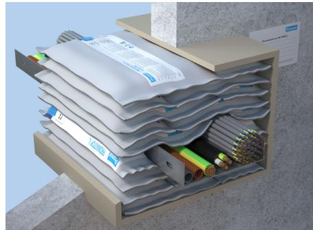
Promastop®-S/-L coussins coupe-feu: obturation dans un mur. Le côté plus long des coussins est placé parallèle à l'intrados. Pour les parois à faible épaisseur, par ex. une paroi de construction légère, l'épaisseur du mur doit être augmentée à 320 mm sur les quatre côtés avec des panneaux coupe-feu. Le câble et le chemin de câbles doivent être suspendu à environ 250 mm.
