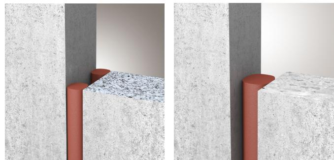
Installation von zwei (links) oder einem (rechts) ZZ® Fugenprofil in einer Massivwand. Bei der Installation von einem Fugenprofil wird dieses mittig in der Wand positioniert (nur für ZZ® Fugenprofile 55, 65 und 75).
