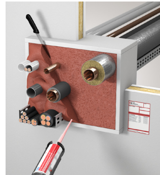
Obturation combinée: occupation max. = 60% de la surface de l'ouverture
