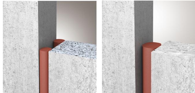
Installation de deux (gauche) ou un (droite) profilés ZZ® dans une paroi massive. Quand un seul profilé de joint est installé, il est positionné au centre du mur (seulement pour profilé ZZ® 55, 65 et 75).
