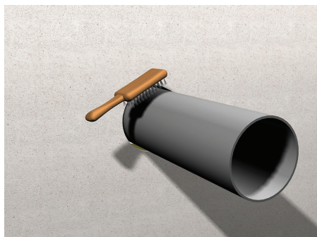
1. Rohr und Kernbohrung reinigen.
