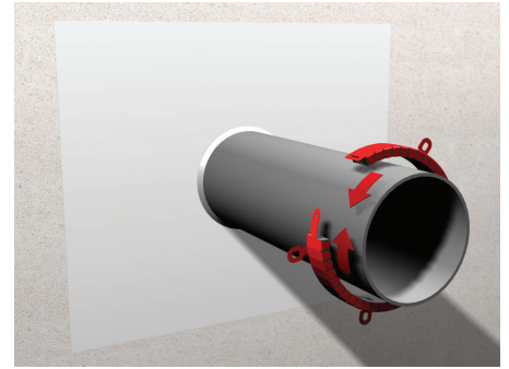
3. Die Brandschutzmanschette Intumex® RS10 um das Rohr platzieren und zum Verschliessen die Lasche um 180° biegen.
