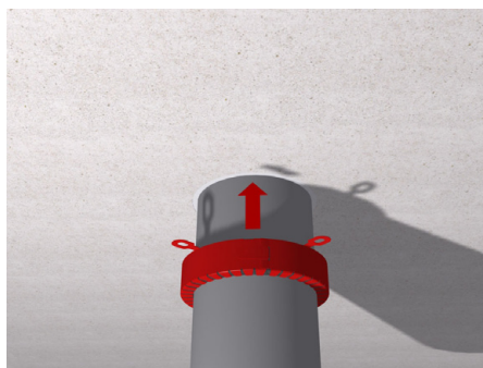
5. Die Brandschutzmanschette mit den mitgelieferten Schrauben direkt an die Unterseite der Decke montieren.
