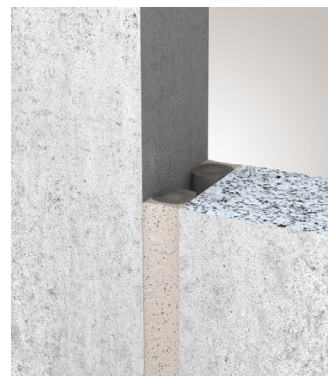
Mit PE/ PUR Rundschnur als Hinterfüllung und beidseitigem Einbau
