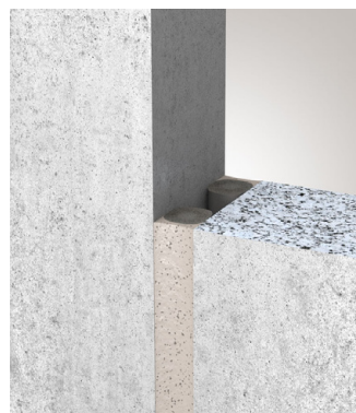
Avec cordon rond PE/PUR comme fond de joint et mise en place bilatérale
