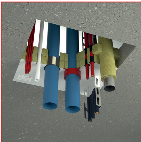
Brandabschottungen Obturations coupe-feu Sigillature tagliafuoco
