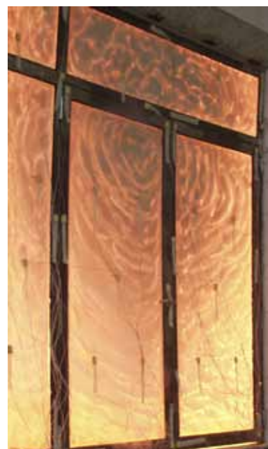
Brandschutztest EI 30 mit 2-flüg. Türe Stahl/ Glas mit INTUMEX LSK
