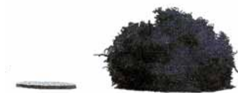
INTUMEX L in rohem und aufgeblähtem Zustand
