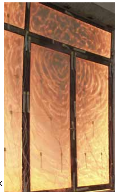
Test anti-feu EI 30, acier / verre avec 2 battants. Porte avec INTUMEX LSK
